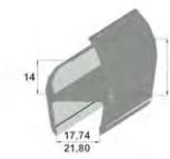
Joint d'étanchéité portes du container
