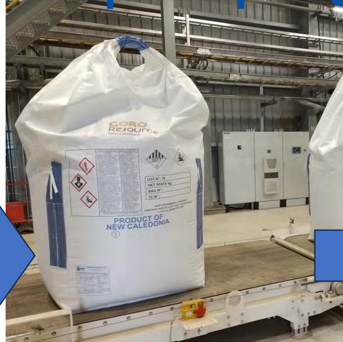
Big Bag 1t à double enveloppe (étanchéité + résistance mécanique)
