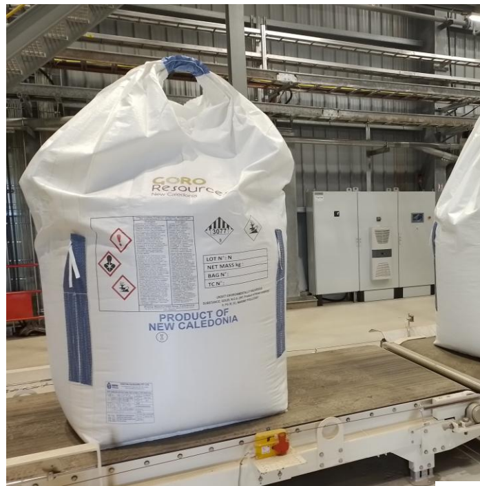
Big Bag 1t double enveloppe (étanchéité + résistance mécanique)
